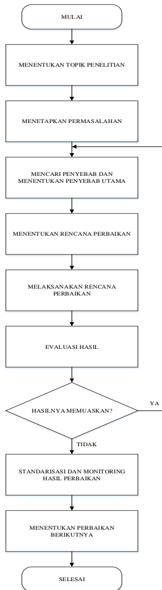
Gambar 3.2 Flowchart Pengendalian Kualitas Dengan Pendekatan 8 Langkah Perbaikan
