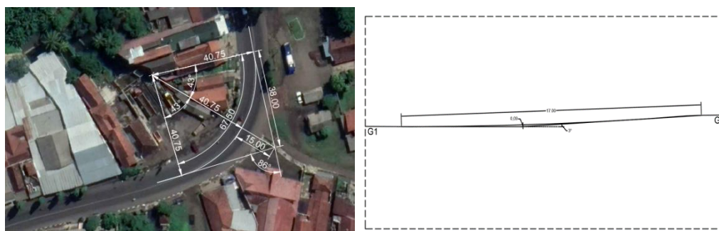
Gambar 3: Kemiringan vertikal Tanjakan Emen Ciater Kabupaten Subang
