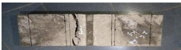
Gambar 4: Pola retak pada pelat
