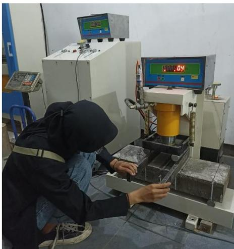
Gambar 3: Pengujian kuat lentur pelat beton.
