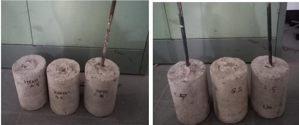
Gambar 6: Kerusakan Pada Beton Panjang Penyaluran 50 mm
