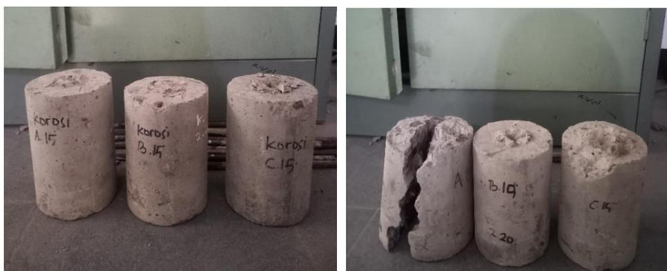
Gambar 4: Kerusakan Pada Beton Panjang Penyaluran 150 mm
