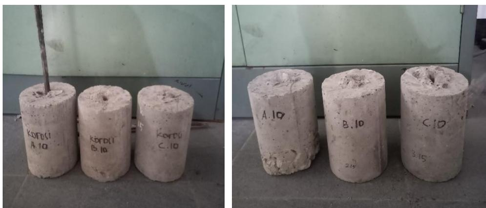
Gambar 5: Kerusakan Pada Beton Panjang Penyaluran 100 mm
