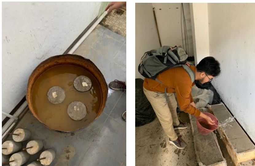
Gambar 4: Hasil Perawatan Beton Silinder dan Balok Beton
