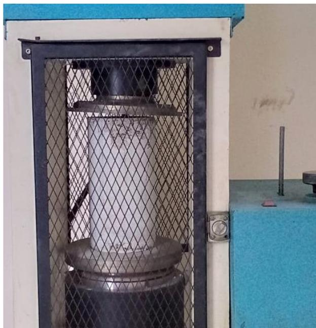
Gambar 2. *Set-up* Uji Tekan Benda Uji
