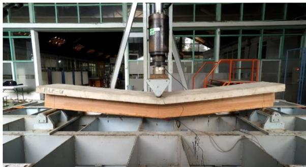
Gambar 1: Ilustrasi Pengujian Lentur Balok Komposit
