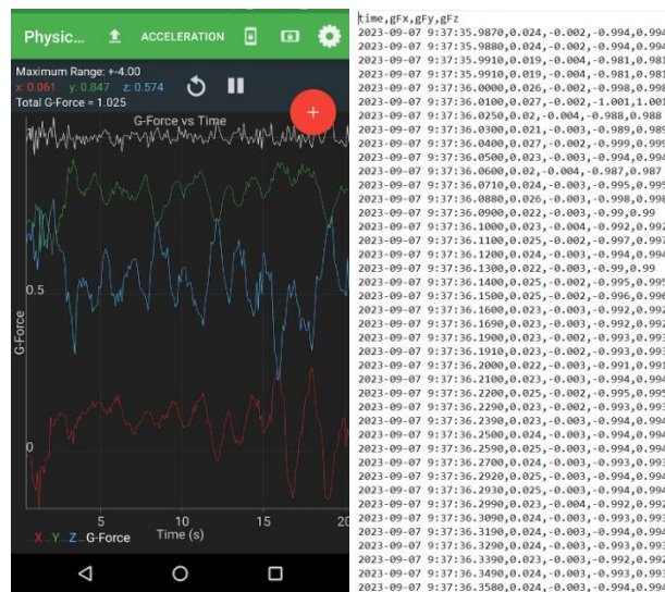
Gambar 7. g-force pada i-phone 11 dan hasil rekaman percepatan dalam format *.csv
