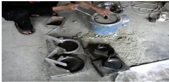
Gambar 5. Pembuatan Kaping Untuk Benda Uji Silinder
